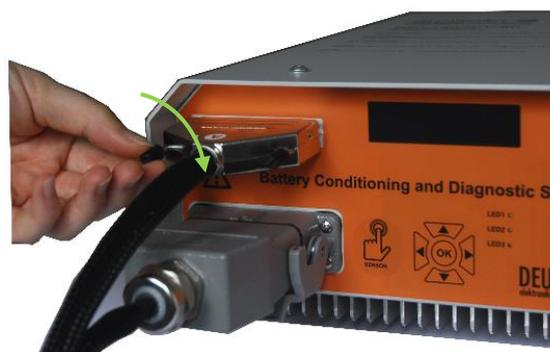
Wurde einer der Anschlüsse nicht kontaktiert, wird der fehlende Anschluss über das Display angezeigt. Um in das Menü für den Konditionierungsbetrieb zu gelangen, muss der fehlende Anschluss am Gerät angesteckt werden. Sind beide Anschlüsse korrekt angeschlossen, wird das Menü „BETRIEB“ oder der entsprechende Fehler angezeigt. Eine Übersicht der Statusmeldungen / Fehlermeldungen sind im Kapitel 10 dargestellt.
