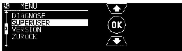
Batterieminimalgrenzwerte und Sicherheitsparameter können nur über das Menü „SUPERUSER“ geändert werden. Um in dieses Menü zu gelangen, ist die Eingabe eines Passworts notwendig. Nach der Auswahl und Bestätigung des Untermenüs erscheint folgendes Fenster zur Abfrage des Passworts:
