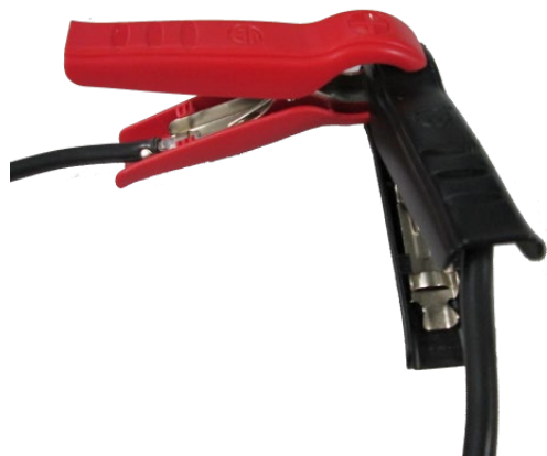
Obrázek 3: Nabíjecí kleště ve zkratu
