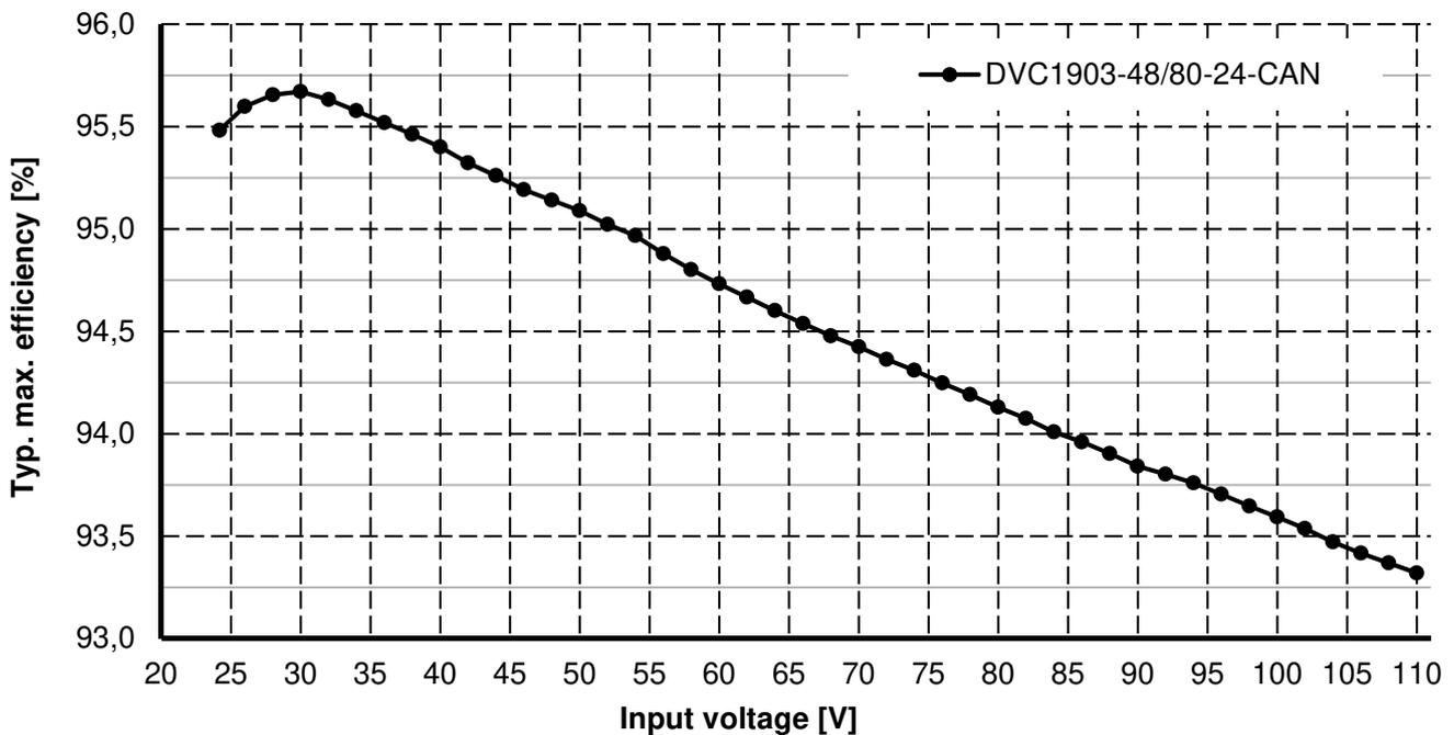
Abbildung 10.6: Max. Wirkungsgrad in Abhängigkeit der Eingangsspannung
