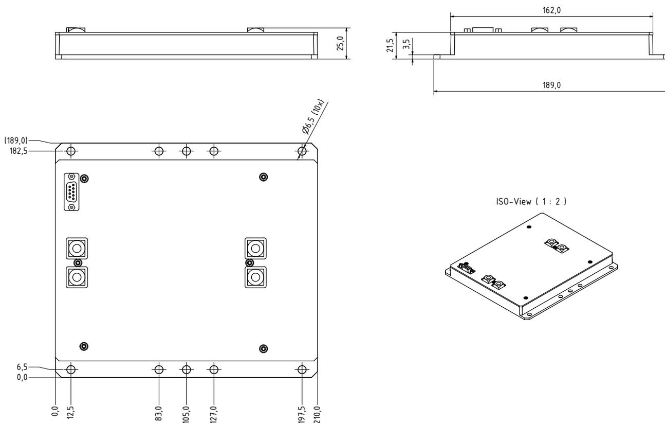
Abbildung 9.1: Abmessungen
