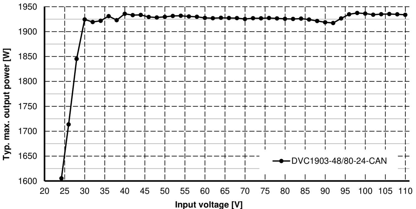
Abbildung 10.4: Maximale Ausgangsleistung in Abhängigkeit der Eingangsspannung
