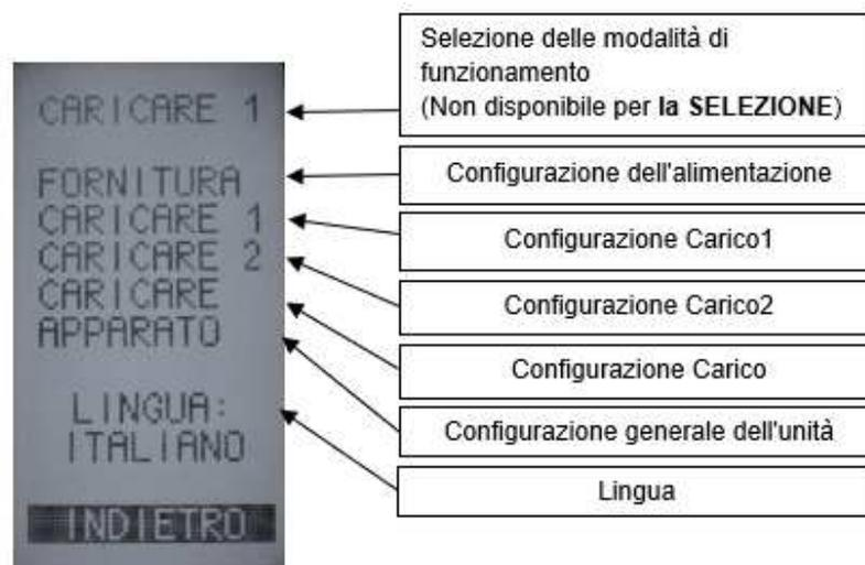
**Figura 5: Menu di configurazione**
