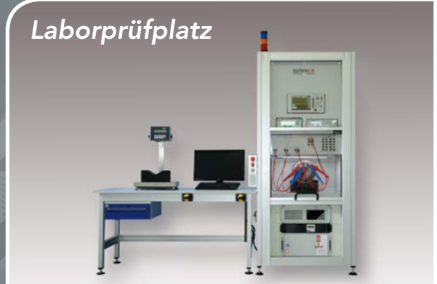
Laborprüfplatz Laborprüfplatz für Stator
