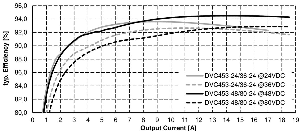
Abbildung 9.2: Wirkungsgrad in Abhängigkeit des Ausgangsstroms
