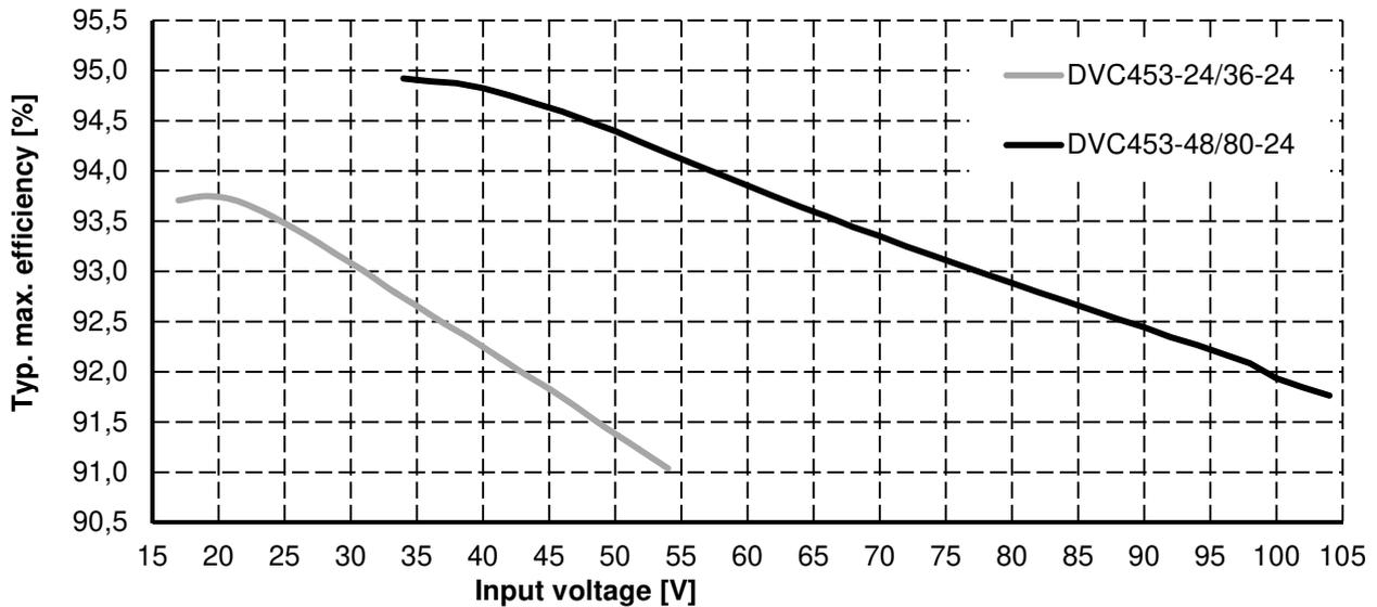
Abbildung 9.3: Max. Wirkungsgrad in Abhängigkeit der Eingangsspannung
