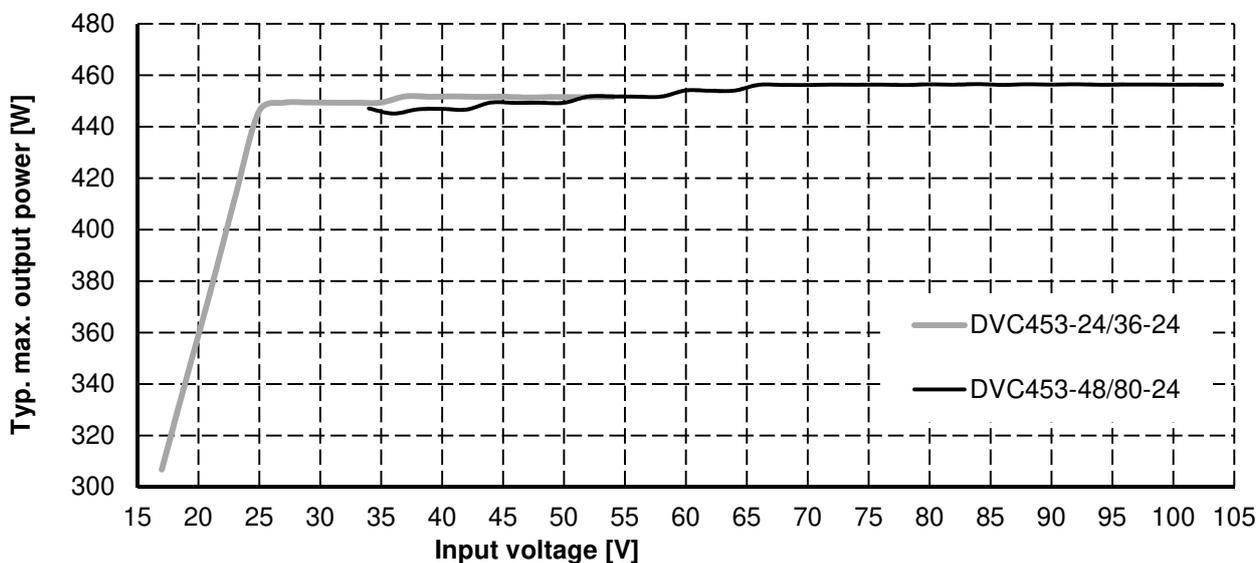
Abbildung 9.5: Typ. maximale Ausgangsleistung in Abhängigkeit der Eingangsspannung
