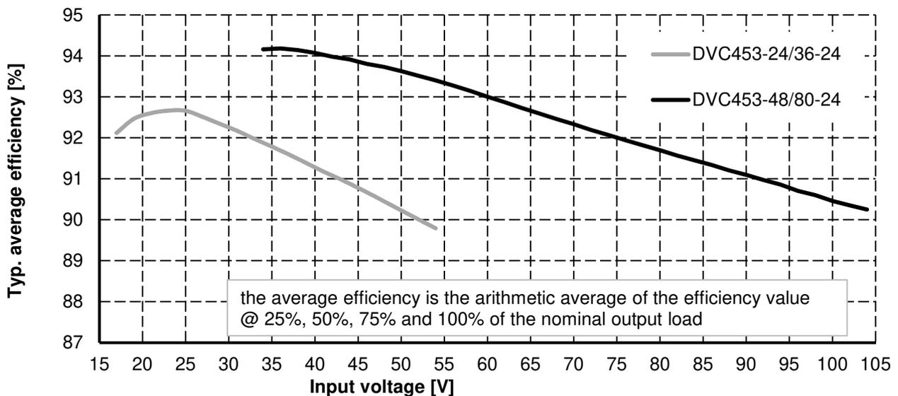
Abbildung 9.4: Durchschnittlicher Wirkungsgrad in Abhängigkeit der Eingangsspannung
