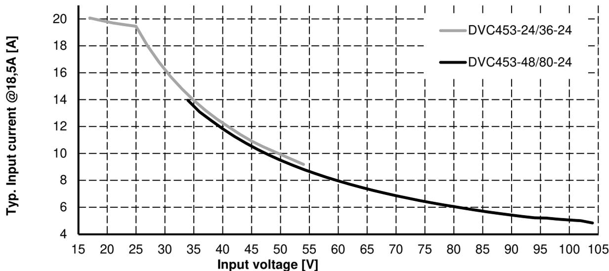
Abbildung 9.1: Stromaufnahme bei Vollast in Abhängigkeit der Eingangsspannung
