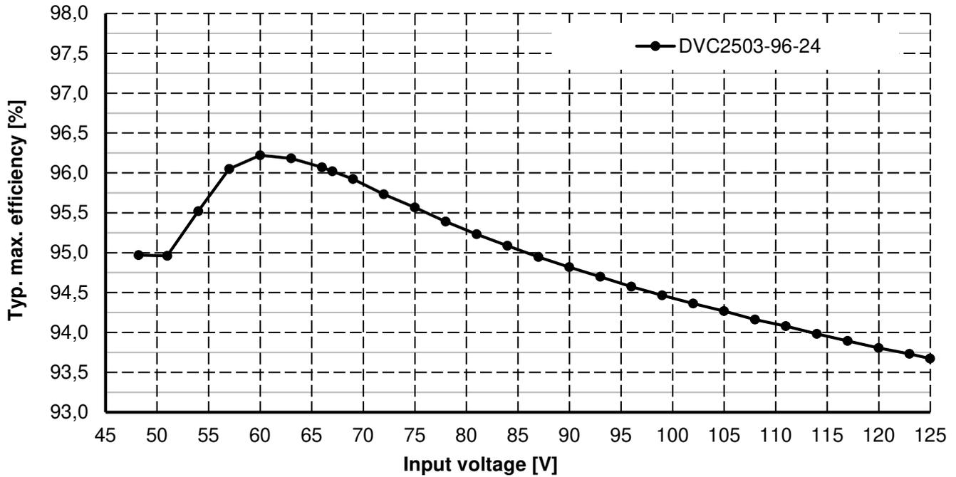
Abbildung 10.3: Max. Wirkungsgrad in Abhängigkeit der Eingangsspannung
