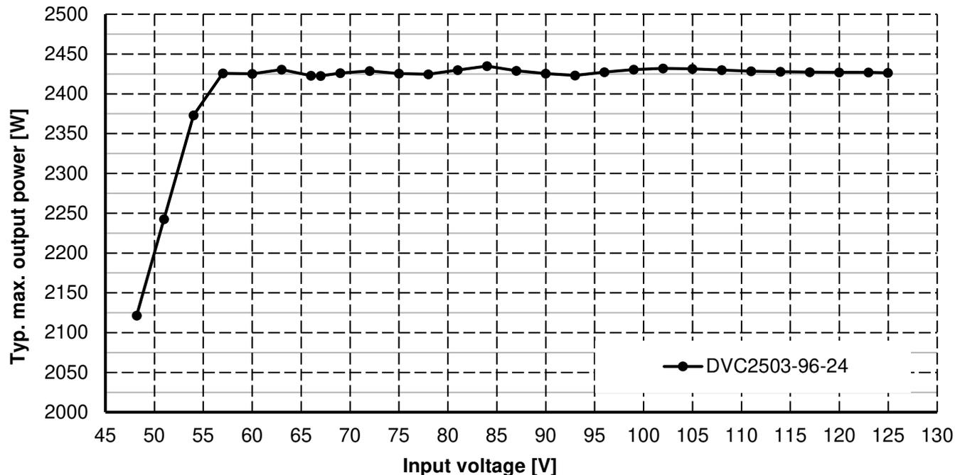
Abbildung 10.2: Maximale Ausgangsleistung in Abhängigkeit der Eingangsspannung
