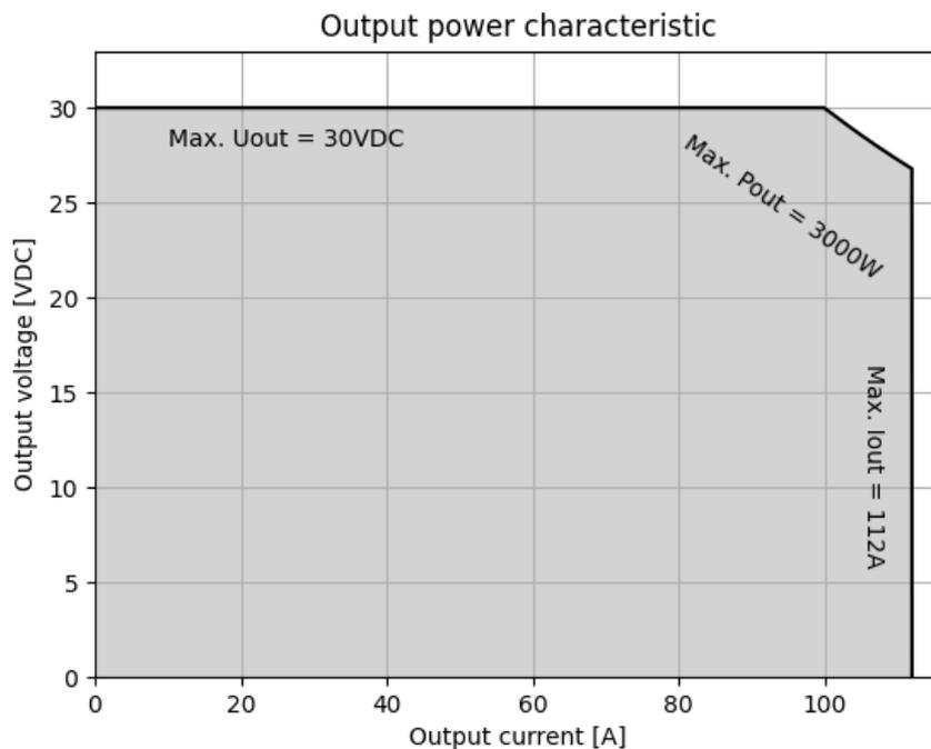
Abbildung 9.2: Ausgangsleistung DVCH3003-700-24
