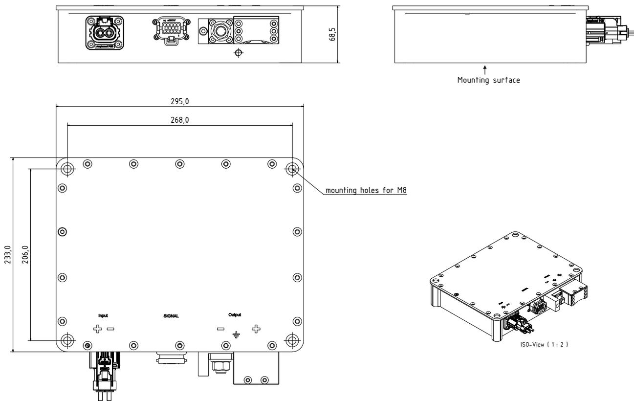
Abbildung 8.1: Abmessungen
