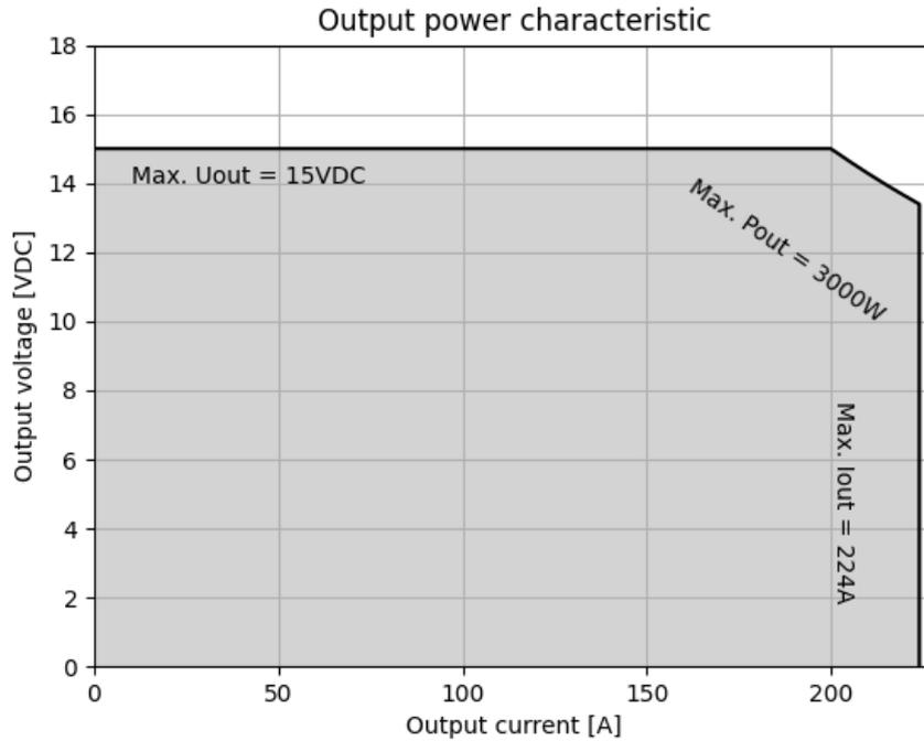
Abbildung 9.1: Ausgangsleistung DVCH3003-700-12
