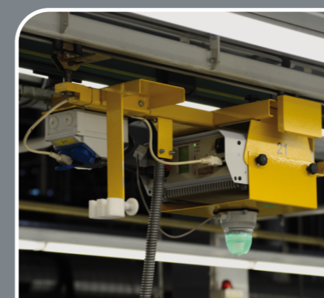
Einsatz Ladegerät mit Signallampe in der Fahrzeugfertigung
